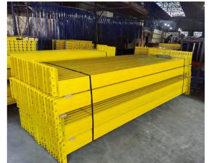
Box beam 横梁
