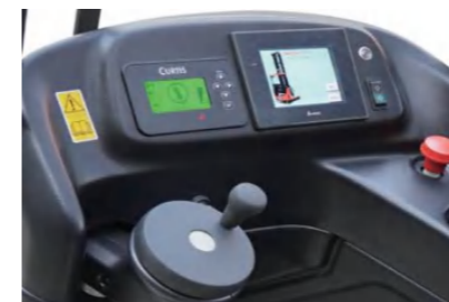
Multi-functional color LCD instrument panel 多功能彩色液晶仪表
