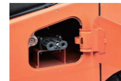
Li-ion charging port 锂电充电口
