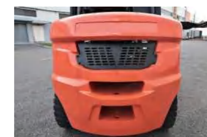
Защитная сетка на вентиляционном отверстии. Heat sink vent cover
