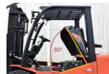
Открытие капота на 80°. Hood opens to 80°
