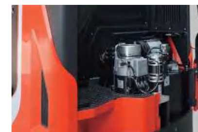
Шестеренчатый насос низкого шума | Low-noise gear pump
