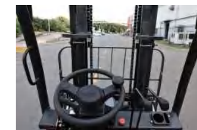
Уширенная мачта для лучшего обзора. Wider mast for better visibility.
