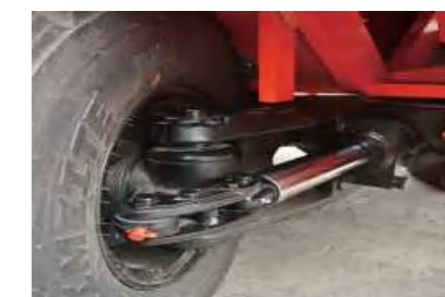
Литейный мост для вилочных автопогрузчиков с ДВС. Cast Steering Axle for Internal Combustion Forklift
