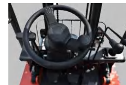
Рулевое колесо меньшего диаметра снижает утомляемость оператора. Smaller steering wheel reduces operator fatigue.
