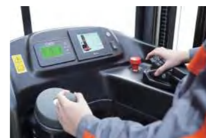
Центральная панель управления | Centralized central control console
