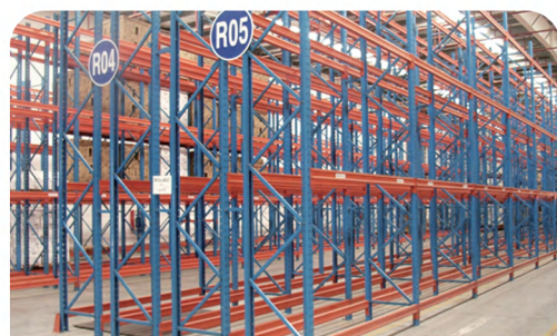
Двухглубинные стеллажи Double-Deep Rack
