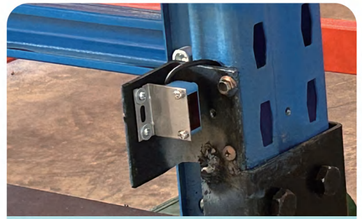
Инфракрасный датчик Infrared sensor
