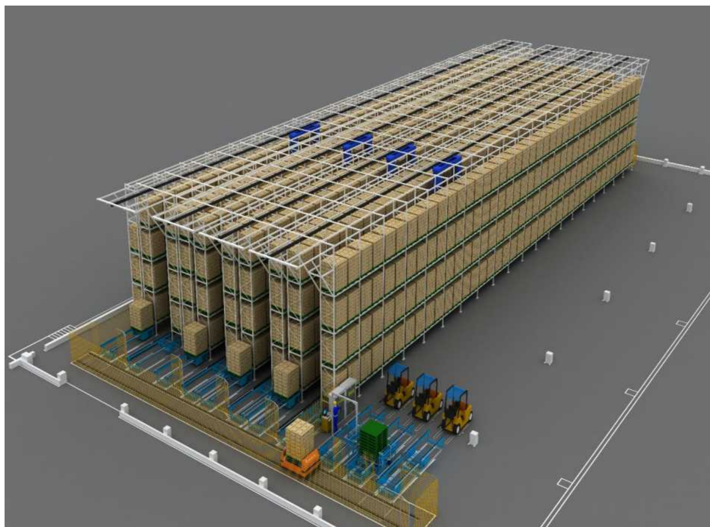
Автоматизированная система стеллажного хранения AS/RS Automation warehouse AS/RS system
