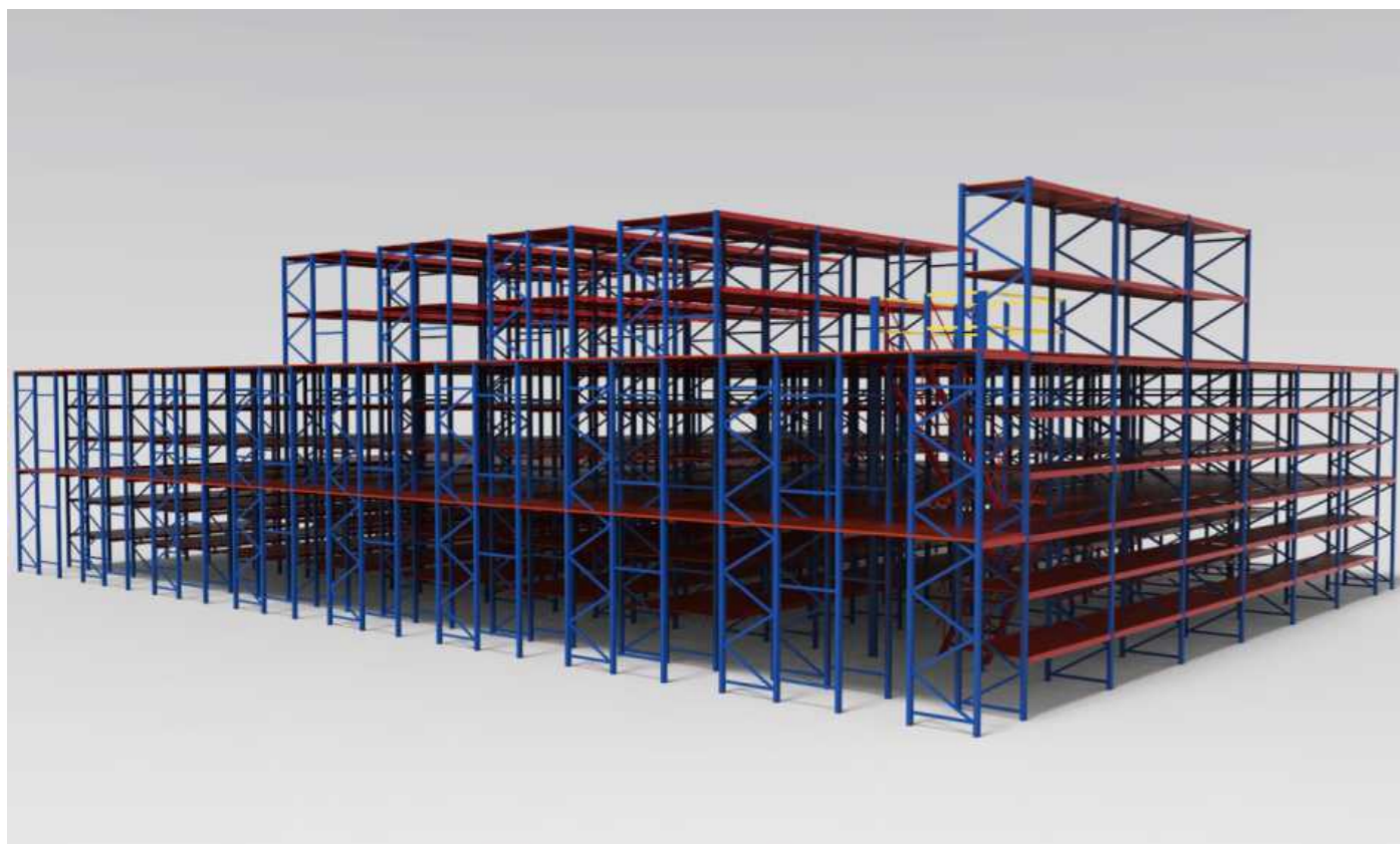
3D-модель стеллажа типа "мезонин" 3D View of Mezzanine rack
