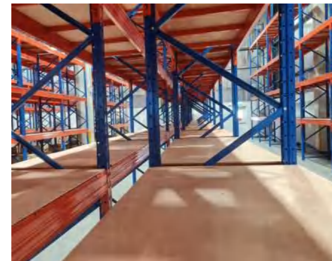
Стеллаж с деревянным настилом Rack with plywood
