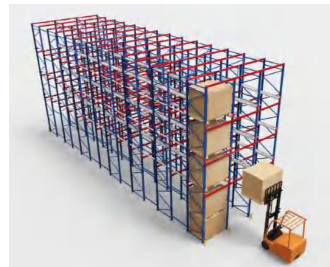
3D-чертеж въездных стеллажей Drive-in rack 3D view
